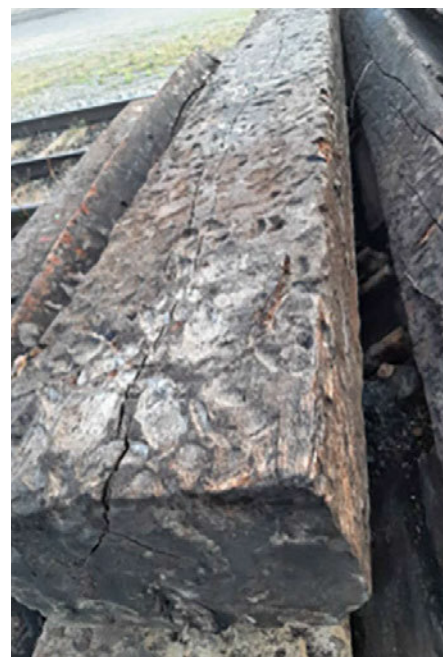
Abb. 4: Verzahnung Schotter mit Holzschwelle
