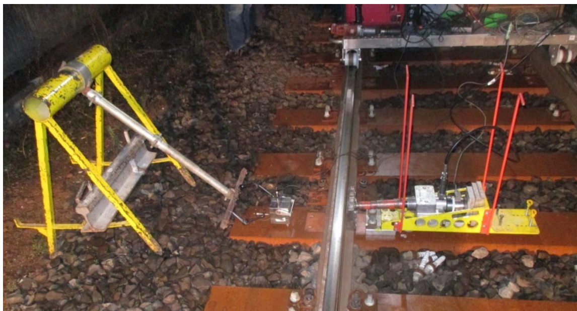
Bild 1: Versuchsaufbau zur Messung des QVW im Betriebsgleis an FFU-Kunstholzschwellen Fig. 1: Experimental setup for measurement of the lateral displacement resistance of FFU synthetic wood sleepers in track
